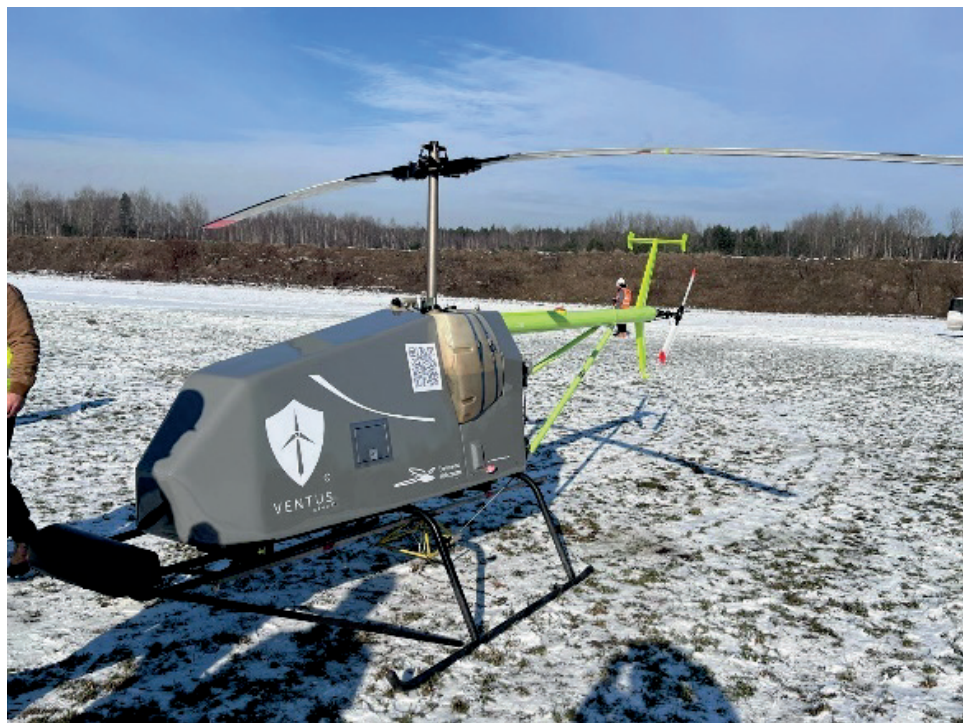
Rysunek 8.2. Bezzałogowy system helikopterowy o udźwigu 200 kg produkcji firmy Unmanned Helikopters
