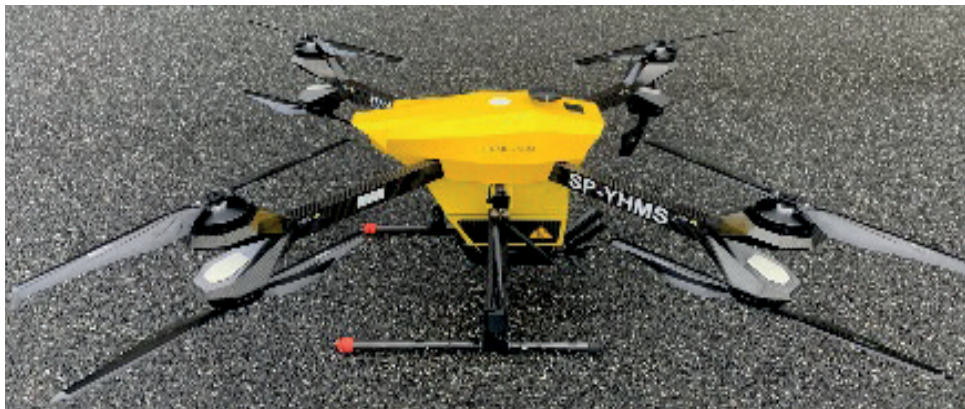
Rysunek 8.5. Ośmiosilnikowy kopter HERMES V8M produkcji firmy Spartaqs
