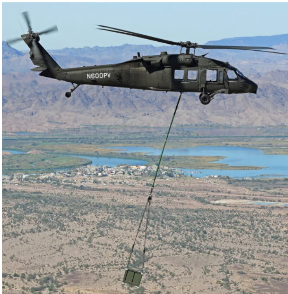
Rysunek 8.1. Helikopter załogowy przekonwertowany na bezzałogowy, mogący unieść ładunek ok. 200 kg
